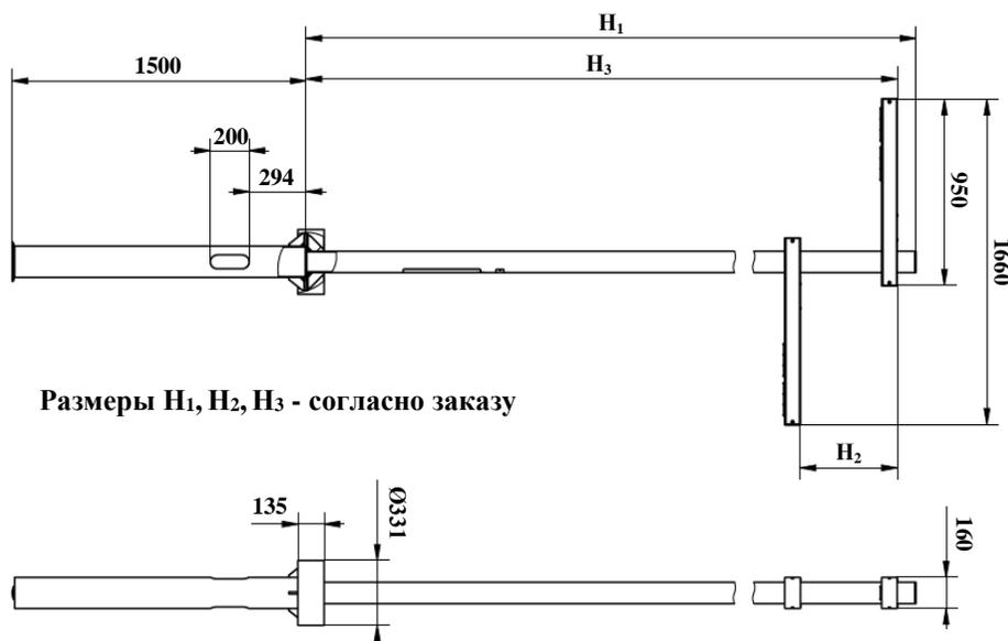
Рис.1 Габаритный размер светильника
